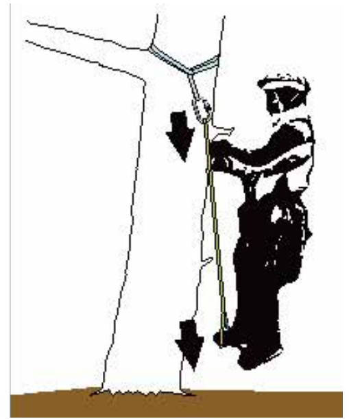
図 1 - 12 立ち木での仮荷重テスト
